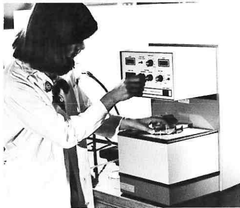
"Laser Colony Counter" för snabb bestämning av antal bakteriekolonier på eller i agarmedier. Laser Colony Counter for rapid counting of bacterial colonies on or in agar media.
